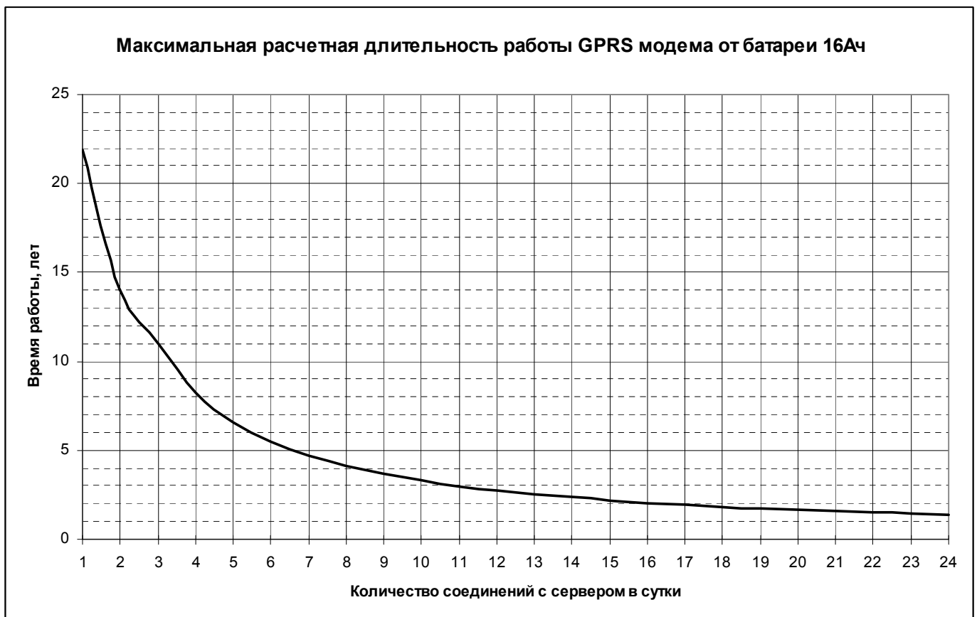
Рис. 2. Зависимость продолжительности работы батареи счетчика от минимальной длительности импульса и частоты связи с сервером для диапазона 1...200мс.
